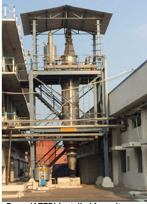
Agitated Thin Film Dryer (ATFD) installed for salt recovery in dyeing units சாயப்பட்டறைகளின் உப்பினை பிரித்தெடுக்கும் உளர்த்தி
