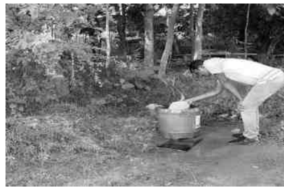
படம் 3.20 மண் வேதியியல் பகுப்பாய்விற்காக மோட்டார் பொருத்தப்பட்ட ஆகரைப் பயன்படுத்தி மண் மாதிரி சேகரிப்பு.
