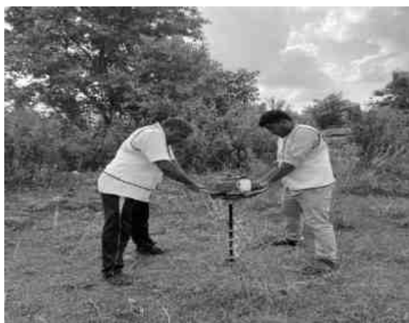
படம் 3.20 மண் வேதியியல் பகுப்பாய்விற்காக மோட்டார் பொருத்தப்பட்ட ஆகரைப் பயன்படுத்தி மண் மாதிரி சேகரிப்பு.
