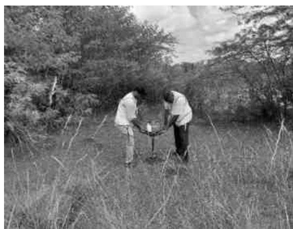
படம் 3.20 மண் வேதியியல் பகுப்பாய்விற்காக மோட்டார் பொருத்தப்பட்ட ஆகரைப் பயன்படுத்தி மண் மாதிரி சேகரிப்பு.
