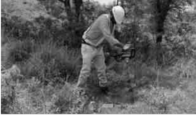
படம் 3.22 (அ) மண் வேதியியல் பகுப்பாய்விற்காக மோட்டார் பொருத்தப்பட்ட அக்கியைப் பயன்படுத்தி மண் மாதிரி சேகரிப்பு
